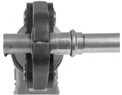
Figure 7 – RP 340 perpendiculaire au tube
