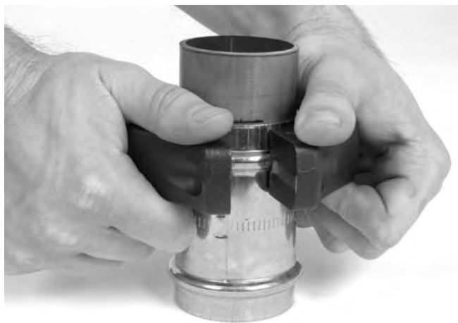
Figura 8 – Montaje del aro sellador en el acoplamiento
