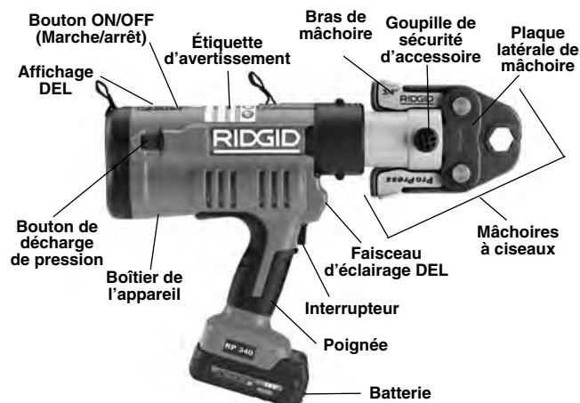
Figure 1 – Sertisseuse RP 340 et mâchoires
