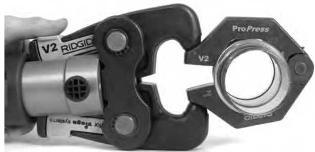
Figura 9 – Montaje del accionador en el aro sellador
