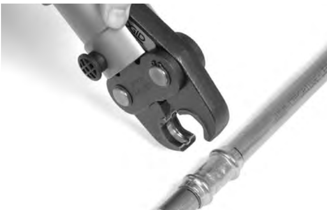
Figure 6 – Ouverture des mâchoires à ciseaux
