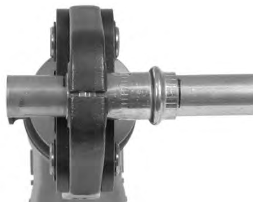
Figura 7 – Selladora RP 340 en posición perpendicular al tubo
