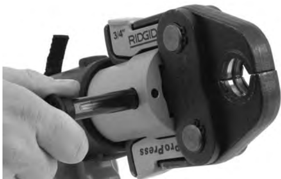
Figure 4 – Goupille de sécurité d'accessoire complètement ouverte
