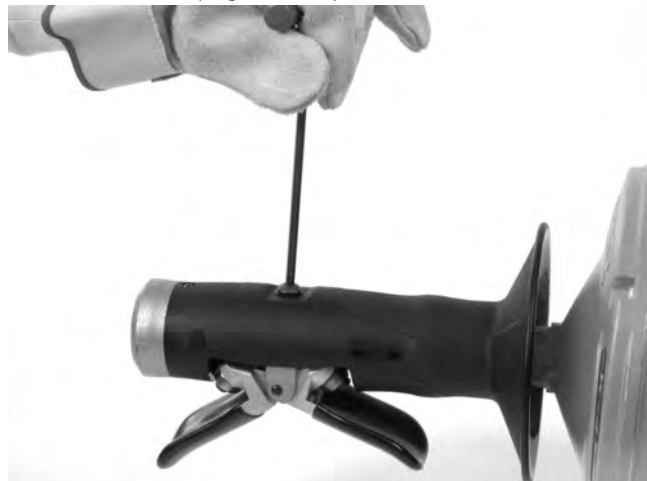
Figure 12A – Retrait de la vis de l'AUTOFEED
