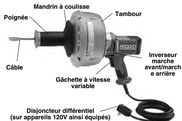
Figure 1 – Dégorgeoir K-45 avec mandrin à coulisse
