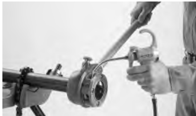
Figure 4 – Application de l'huile de coupe
