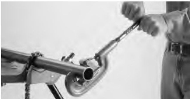
Figure 1 – Coupe de l'extrémité du tuyau
