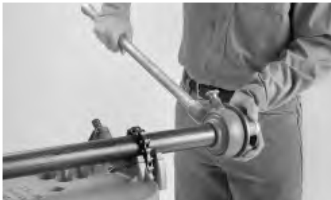
Figura 3 – Montaje de la Roscadora en el tubo
