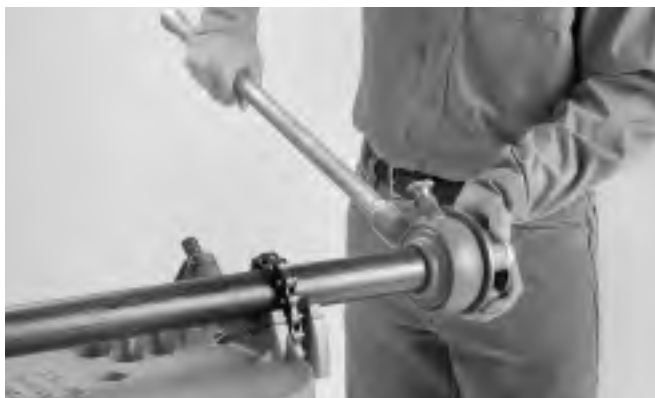
Figura 3 – Montaje de la Roscadora en el tubo
