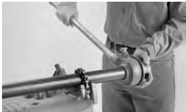
Figure 3 – Montage de la fileteuse sur le tuyau
