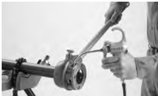
Figura 4 – Aceitado con aceite para cortar roscas
