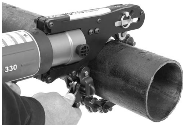
Figure 4 – Ramener la chaîne autour du tuyau
