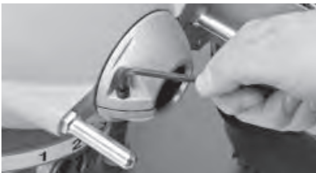
Figura 13 – Eliminación del juego (holgura) del embrague
