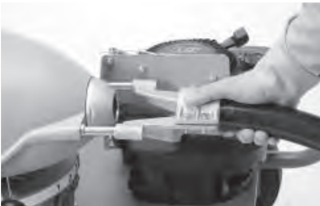
Figura 2 – Acoplamiento de la manguera guía trasera
