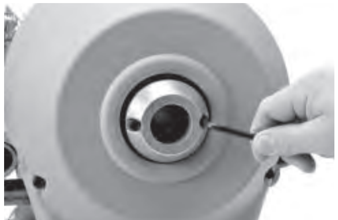
Figure 11 – Remplacement des mâchoires d'embrayage
