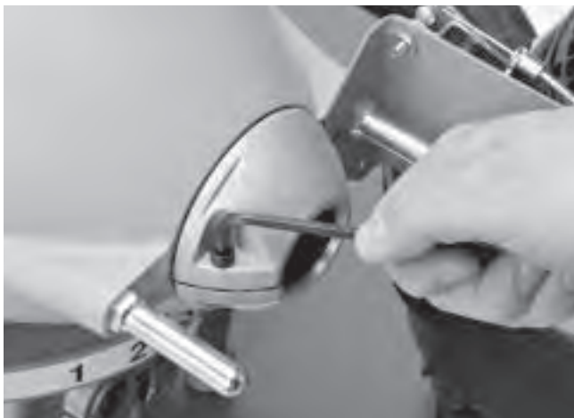
Figure 13 – Élimination du jeu axial de l'embrayage
