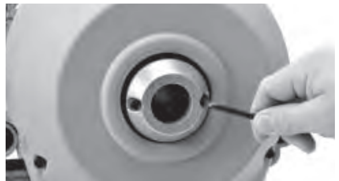
Figura 11 – Recambio de las mordazas del embrague
