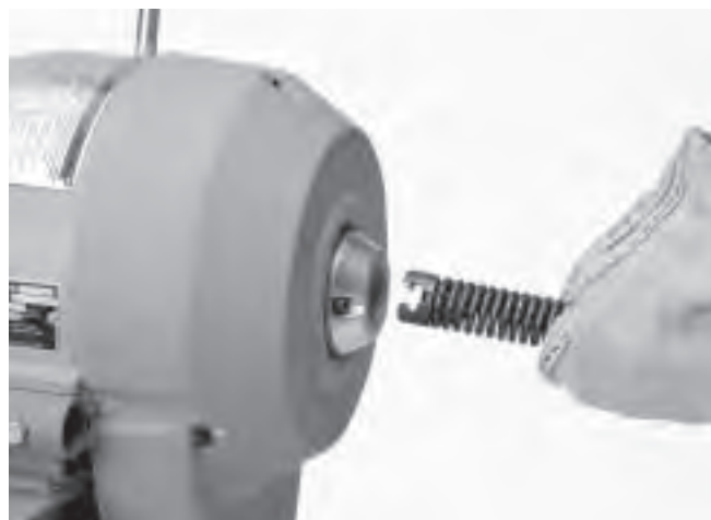
Figure 3 – Insertion du câble à l'avant de la machine
