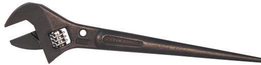
Inutile de transporter plusieurs clés de format fixe lorsque vous avez la clé de construction à tête réglable de Klein Tools. Elle est forgée avec un alliage d'acier de première qualité durable. Un manche à forme conique graduelle aide à l'alignement des trous de boulon et de rivet.
