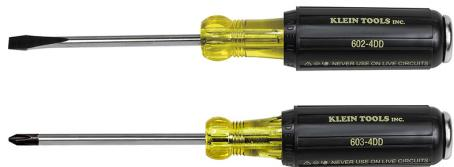
Le jeu de tournevis de démolition de Klein est conçu, fabriqué et testé pour les applications d'arrachage et de gougeage. La tige métallique traitée thermiquement traverse toute la longueur du manche jusqu'à la face de frappe en métal. Ceci transfère la force de l'impact directement à la surface de travail. De plus, la face de frappe en métal protège le manche des coups du marteau. Ce jeu comprend un tournevis à tête cruciforme n° 2 et un tournevis de démolition de 1/4 po.
