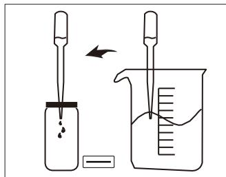
1. Ajouter plus de 10 ml de la solution à tester, serrer le bouchon du flacon et ajouter avec précaution pour éviter les bulles d'air.
