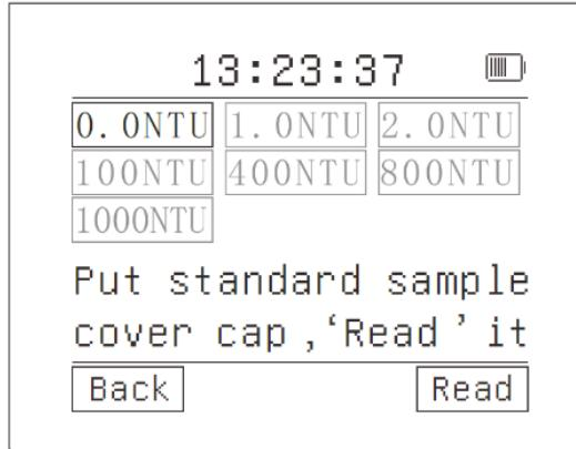
3. Pulse "Back" para cancelar el calibrado y volver a la interfaz principal. Pulse "Read" para entrar en la interfaz "Checking". Cambie automáticamente al siguiente punto de calibración y complete la calibración de 4 puntos de calibración de 0/1/2/100 NTU.
