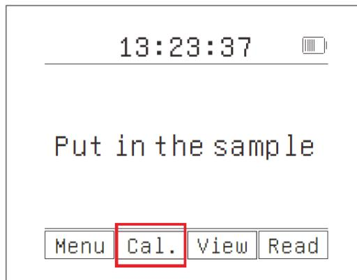
1. Pulse "Calibration" en la pantalla principal para entrar en la pantalla "Confirm Calibrate".
