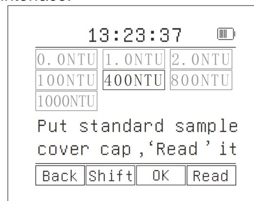
4. Après avoir effectué le premier étalonnage en 4 points, l'interface d'étalonnage suivante ajoute les fonctions "commuter" et "terminer".
