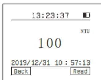
5. Una vez visualizado el resultado de la prueba, pulse "Back" para volver a la interfaz principal; pulse "Read" para realizar la siguiente prueba.
