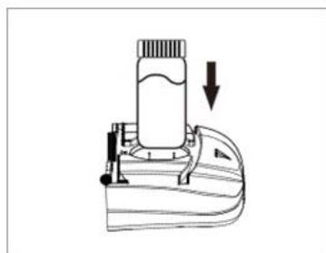
3. Placer le flacon colorimétrique dans la cuve colorimétrique.
