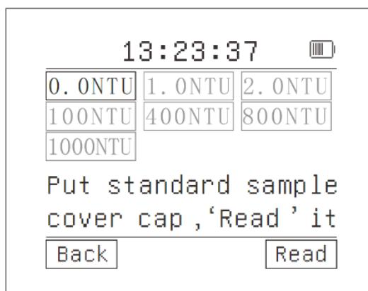
3. Cliquez sur "Back" pour annuler le calibrage et revenir à l'interface principale. Cliquez sur "Read" pour accéder à l'interface "Checking". Passez automatiquement au point d'étalonnage suivant, puis terminez l'étalonnage de 4 points d'étalonnage de 0/1/2/100 NTU.
