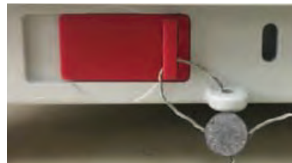
Bloccato con Sigillo di Cavo
