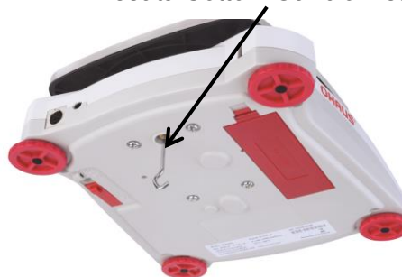
Pesata Sotto il Gancio installato
