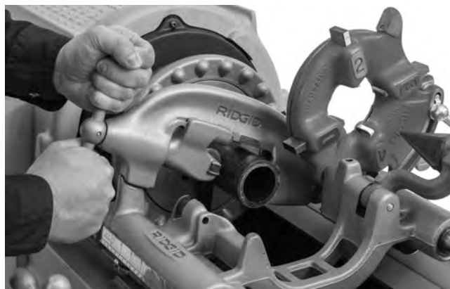
Figure 21 – Coupe-tube en marche
