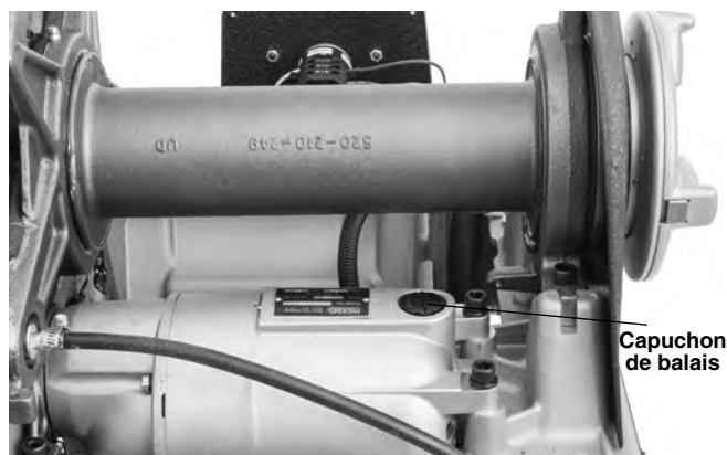
Figure 34 – Retrait du capot et remplacement des balais
