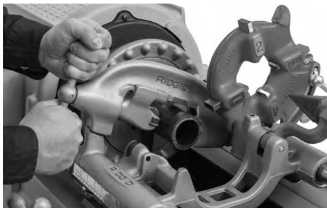
Figure 21 – Coupe-tube en marche
