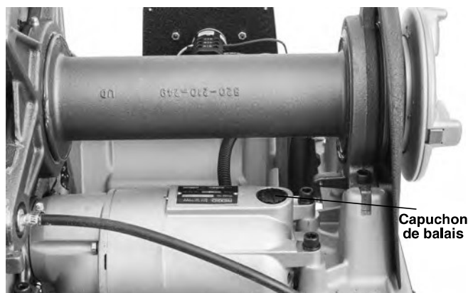
Figure 34 – Retrait du capot et remplacement des balais
