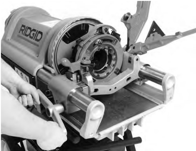
Figure 23 – Filetage des tuyaux (ici, à l'aide d'une tête de filière n° 714)
