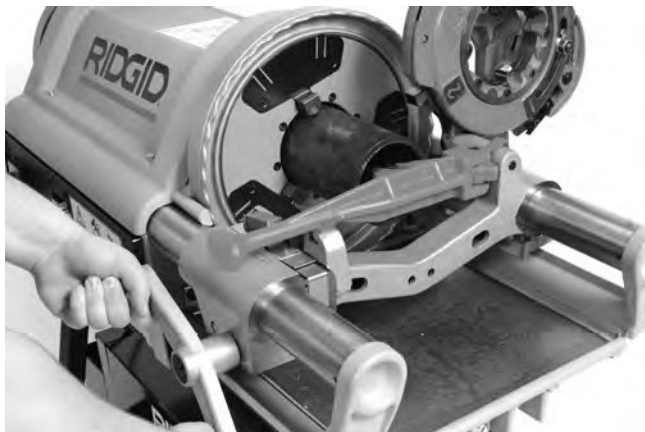
Figure 22 – Alésage du tuyau
