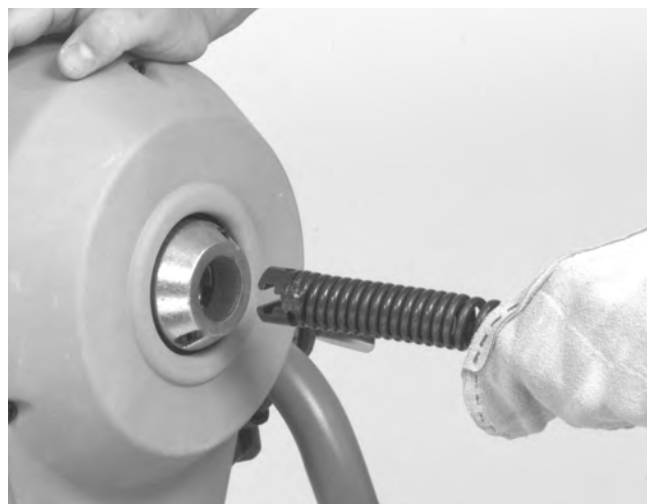
Figure 4 – Introduction du câble via l'avant du dégorgeoir
