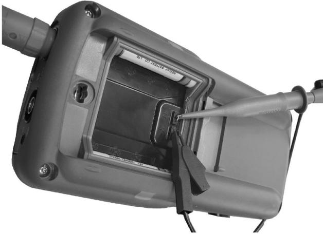
Connectez la sonde à régler sur la sortie calibration se trouvant derrière cette trappe, comme indiqué ci-contre.
