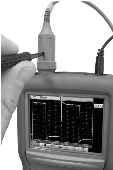
Dans notre exemple ci-contre, la sonde est sur-compensée : un dépassement apparaît.
