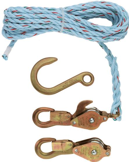
Tous les palans à moufles Klein utilisent des cordes de 10 mm (3/8 po) de diamètre de qualité supérieure. Les caisses de poulie en acier galvanisé léger sont munies de crochets de décélération pour retenir la charge. Cet emballage contient deux moufles dotés d'un crochet d'ancrage standard dont la charge maximale sécuritaire est de 340 kg (750 lb).
