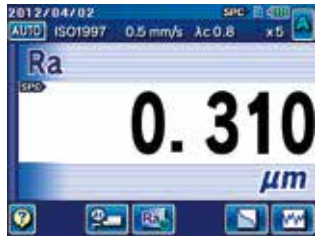
1-parameter display: one parameter measurement result
