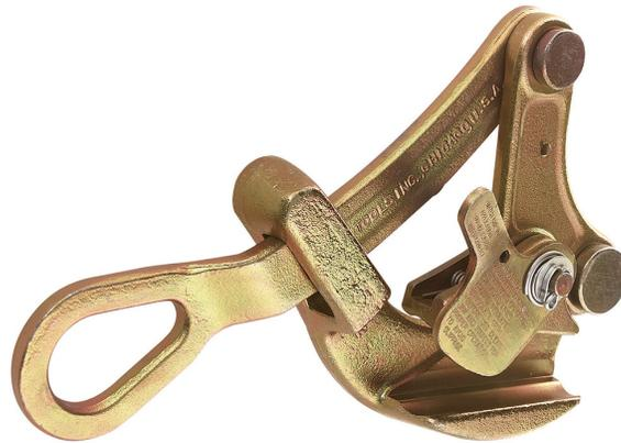
Tire-fils compacts et légers tirant une gamme exceptionnellement vaste de tailles et de types de câbles. Conçu avec un contour intérieur de mors rond pour un contact maximum, afin de minimiser les dommages au conducteur. Le mors inférieur est dentelé, pour saisir fermement les câbles isolés et les conducteurs. Le design comprend une clavette qui empêche le tire-fils de tomber si le mors se désengage du câble.
