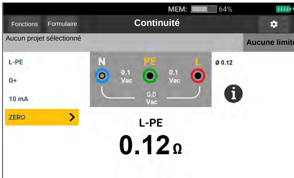
Figure 10. Ecran de mesure de continuité
