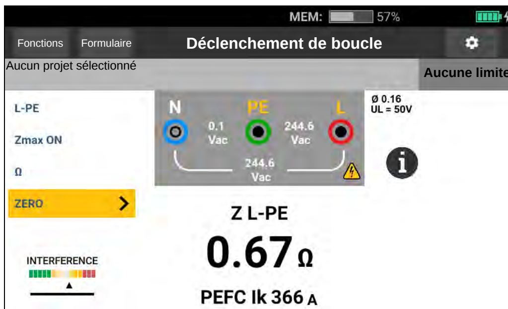
Figure 12. Ecran de mesure de déclenchement d'impédance de boucle
