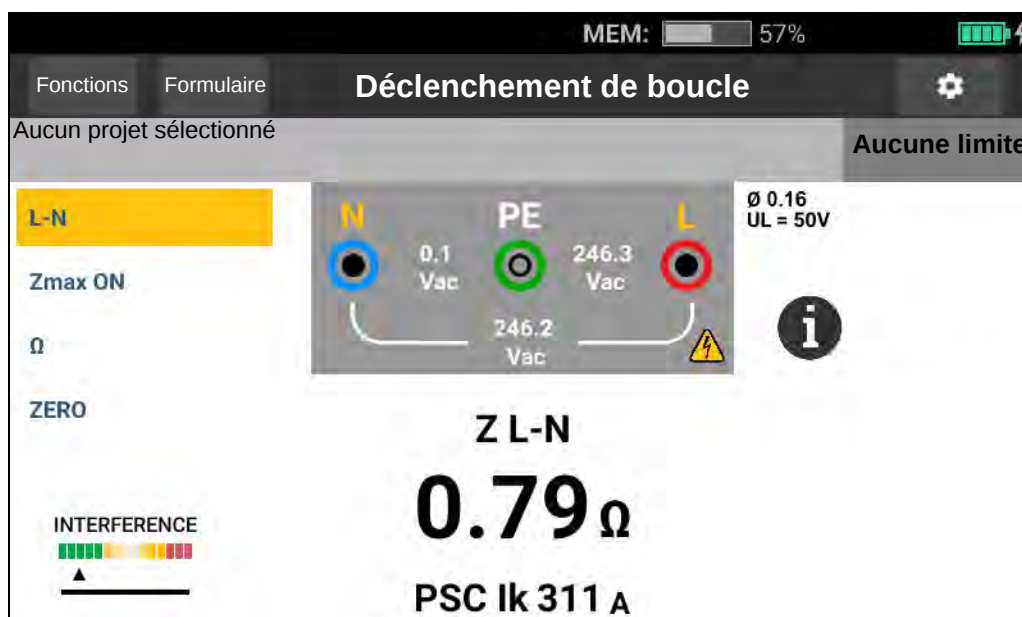
Figure 13. Ecran de mesure de l'impédance de ligne
