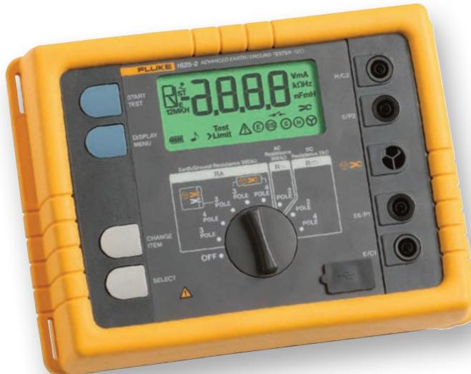
terre en utilisant uniquement des pinces. Avec cette méthode de test, deux pinces sont placées autour de la tige de terre et chacune d'elles est reliée au testeur. Aucun piquet de terre n'est utilisé. Une tension connue et fixe est induite par l'une des pinces et le courant est mesuré en utilisant la seconde pince. Le testeur détermine automatiquement la résistance de la tige de terre.
