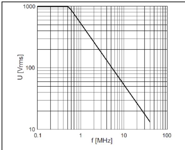
Figure 15. Tension et fréquence d'entrée maximale pour BB120 et STL120-IV hpp049.eps
