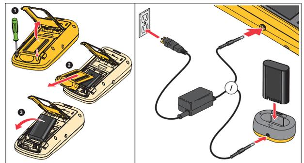
Figure 2. Mise en charge de la batterie
