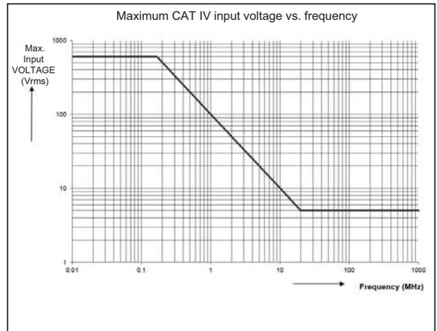
Figure 16. Déplacement en toute sécurité : Tension maximale entre la référence de l'outil de diagnostic et la terre hpp050.ep
