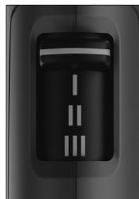
L'outil s'allume et s'éteint en appuyant sur l'interrupteur à trois niveaux situé au dos de la poignée. Le flux d'air et la température peuvent être réglés à 3 niveaux. Le niveau 1 est un niveau d'air froid à 120 °F avec un flux d'air de 4 cfm. Le niveau 2 atteint 750 °F avec un flux d'air de 7 cfm, le niveau 3 atteint 1100 °F avec un flux d'air de 13 cfm. Le manchon de protection peut être retiré du carter de l'appareil permettant d'emboîter des accessoires.
