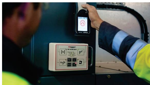
Le boîtier de test commence à fonctionner dès qu'il est allumé et génère des impulsions semblables à des décharges partielles. Le niveau, la fréquence des impulsions et le type de signal, sont émis sur les réglages précédents que vous pouvez ajuster à l'aide des touches situées sur la partie avant du boîtier :
