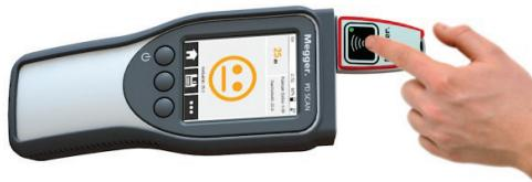
3. Appuyer sur le bouton du testeur de DP pour générer un signal de type DP.
