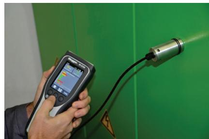
Il est essentiel que ce type de capteur soit utilisé correctement. La tête du capteur doit être placée à plat sur une surface aussi lisse que possible. Même les plus petits interstices d'air peuvent empêcher la mesure des signaux de décharges partielles en cours de mesure.
