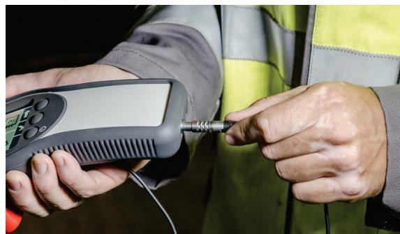
L'appareil détecte automatiquement le capteur connecté dès qu'il est sous tension et propose différents modes de fonctionnement.
