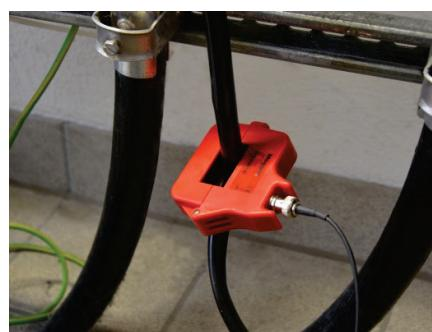
En principe, le PD Scan peut également être utilisé avec d'autres coupleurs HFCT équipés d'un port BNC compatible et accessible. Cependant, l'affichage du niveau peut différer selon le capteur utilisé. Le PD Scan est parfaitement en phase avec le capteur HFCT livré pour garantir un bon niveau de précision des mesures.
