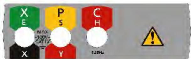
Connexions des câbles de test (à l'arrière de l'appareil)
