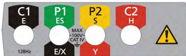
Connexions des câbles de test (à l'arrière de l'appareil)
