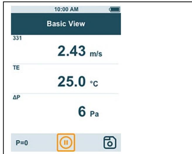
En fonction de la sonde connectée, des paramètres tels que la visibilité de différentes valeurs ou les unités peuvent être réglés pour la mesure.
