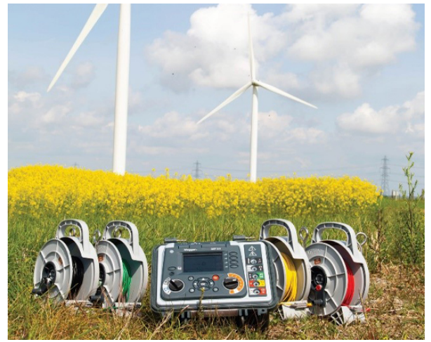
Figure 4: Testeur de résistance de terre avec fils d'essai
